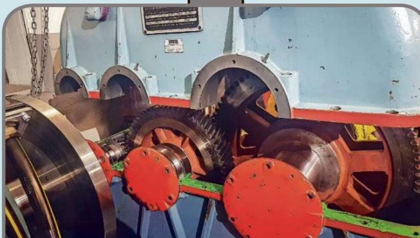
Gehäuseflansch wurde mit Dichtmasse bestrichen, und beim darauffolgenden Schritt erfolgte die Montage des Getriebedeckels.
