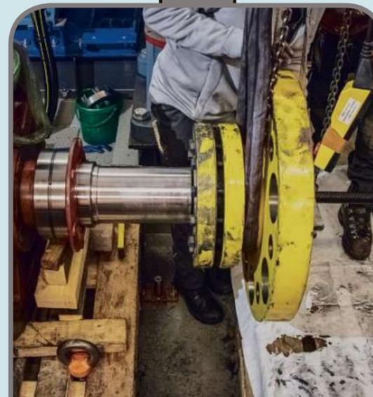
Die Kupplungshälfte wird sorgfältig auf die Antriebswelle montiert und anschliessend mithilfe einer sogenannten «Stüwe»-Schrumpfscheibe auf der Welle festgemacht, sodass eine kraftschlüssige Verbindung zwischen Antriebswelle und Kupplung erstellt werden kann.
