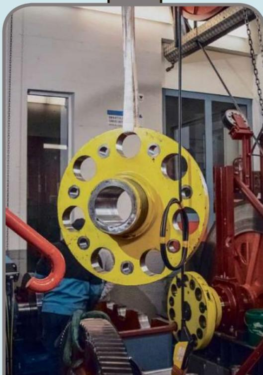
Eine Kupplungshälfte wird mit dem Kran an den Montageort gehievt, und die Montage der Kupplungshälfte wird vorbereitet.
