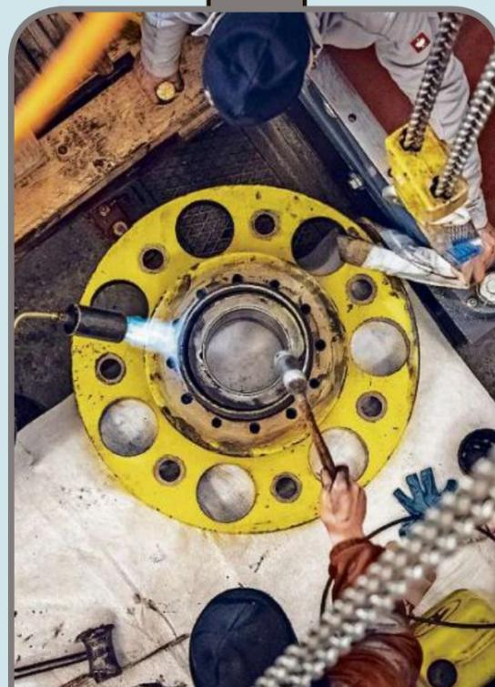
Hier wird ein Ring ebenfalls mit Hilfe von Wärme montiert.
